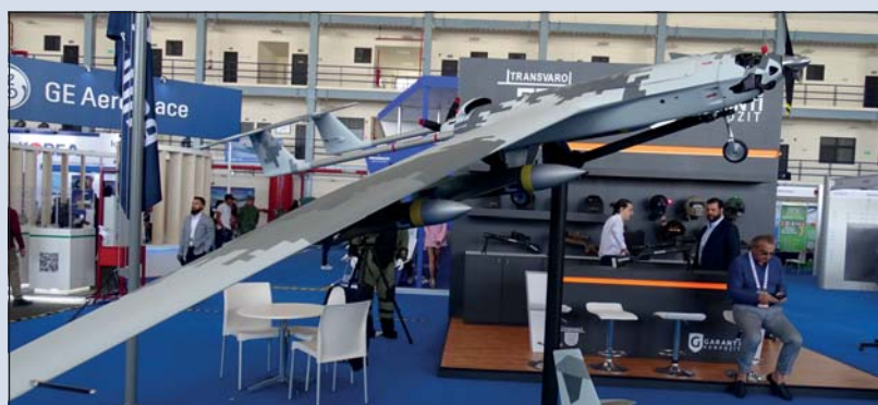
■ Společnost Hydra Technologies nabízí také naváděnou municí Silent Strike; tato fotografie ukazuje bezpilotní prostředek S50 Kukulkán se zavěšenou čtveřicí exemplářů.
