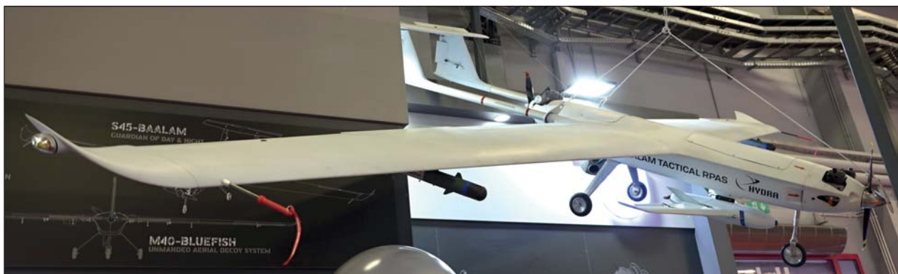
■ Víceúčelový bezpilotní letoun S45 Báalam byl vystaven i jako nosič vyčkávací munice Huul-1 (pod trupem) a lehké naváděné munice Raytheon PIKE (pod křídlem).
